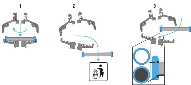
Aufschrauben – alte Kartusche durch neue ersetzen – zuschrauben. So einfach geht's!
